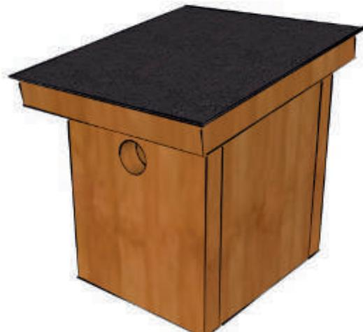
Éventuellement, pose d'une toile bitumée pour l'étanchéité.
