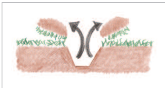
Ill. 36: Réalisation d'un fossé avec une charrue (coupe transversale du sol). Labourer profondément une fois dans chaque sens pour obtenir un fossé bon marché utile pour les petits mustélidés.
